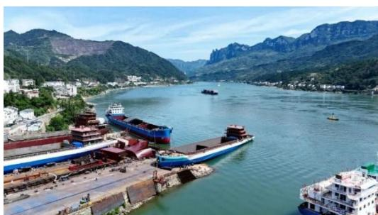
该船舶是宜昌市首批建造的两艘 3000 吨级，过坝磷矿绿色运输标准船型示范船之一。两艘船均搭载潍柴 6WH17 纯甲醇发电机组，船体总长 99 米，型宽 16.3 米，型深 4.8 米。
