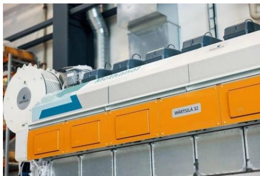
图 2 Wartsila32 甲醇-柴油双燃料四冲程发动机
