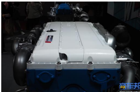
深埋式的点火系统设计
