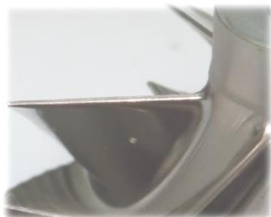
带镍磷涂层压气机叶轮
